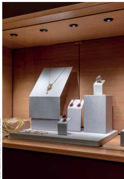
Acima, vitrines de joalheria com aproximadamente 2000 lux usando a técnica LED + Fibra Ótica.
